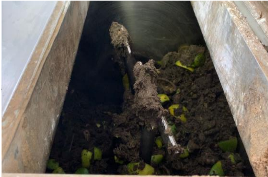
Figura 1: mistura dos resíduos orgânicos com os demais elementos para fazer a compostagem
